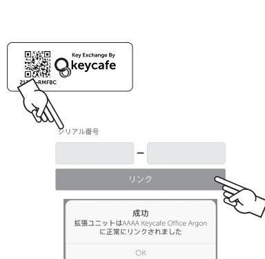
拡張用端末の右側面に印字されているシリアル番号をアプリ画面に入力して、「リンク」をタップします。
