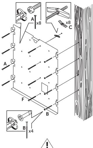
**IMPORTANT :** Alignez une rangée de trous le long d'un montant dans le mur et utilisez la vis B.
