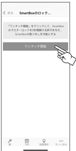
「SmartBoxのロックを解除」のダイアログボックスで、「ワンタッチ開錠」をクリックします。
